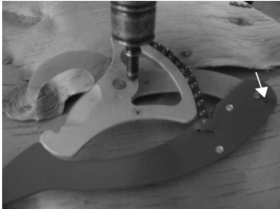
Kuva 5. Pystykarsintalaitteen kaksi voitelukohtetta nivelien voitelemiseksi.
