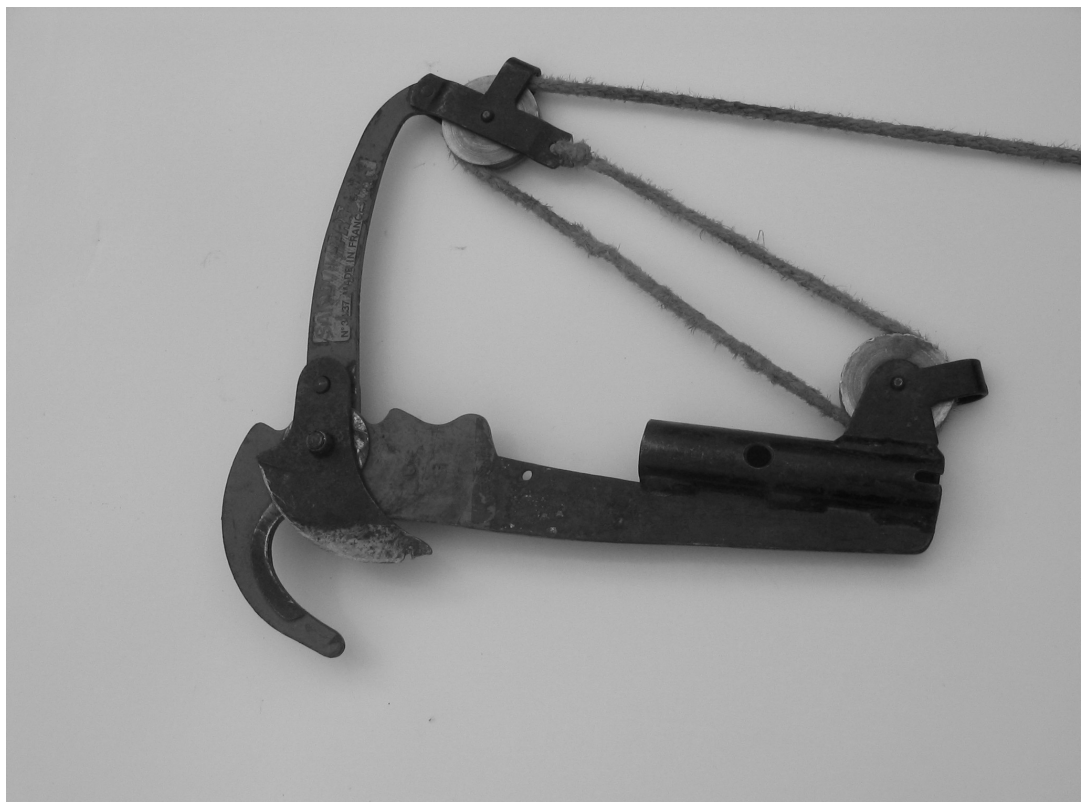
Kuva 2. Sandvikin pystykarsintalaite narulla vedettävine taljoineen.
