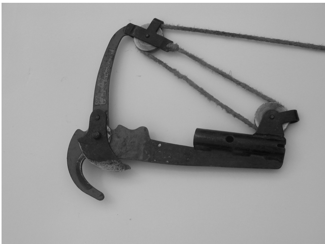
Bild 2. Sandvik stamkvistningsredskap med taljor för hand-dragning.
